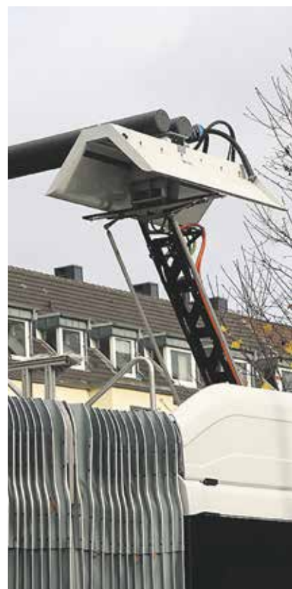
Der Pantograf eines E-Busses
