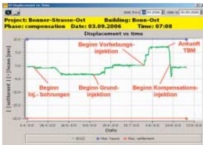
12 Höhenverlauf eines Messpunktes von der Injektionsbohrung bis zur Schilddurchfahrt
