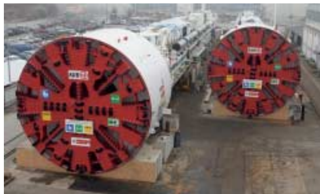
4 Schildmaschinen mit 8,40 m Durchmesser im Baufeld Süd
