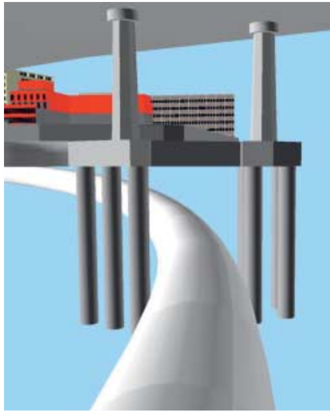
14 Durchfahrung Pfahljoch S-Bahn-Stützen Vortrieb Ost
