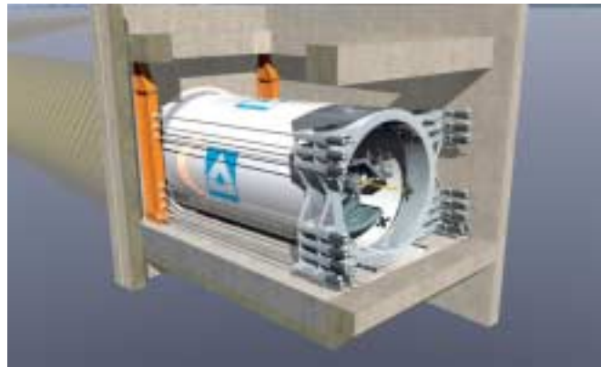
5 Fliegende Schildanfahrkonstruktion mit TBM in Startposition
